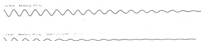
Bild 12. Ausschwingverhalten einer Stahlfeder und einer Rollbalg-Luftfeder bei ähnlicher Belastung
